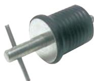
**18.540.00** In acciaio inox con gommino in neoprene. Adattabile a tutte le boccole. Bloccaggio tramite rotazione del traversino. Preferibile ai modelli con eccentrico (18.539.00/535.00 e 18.533.00), quando si operi in spazi limitati o dove si desideri una chiusura meno rapida, ma più sicura. Ø 22 mm.
